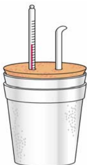
A Simple Styrofoam Calorimeter
